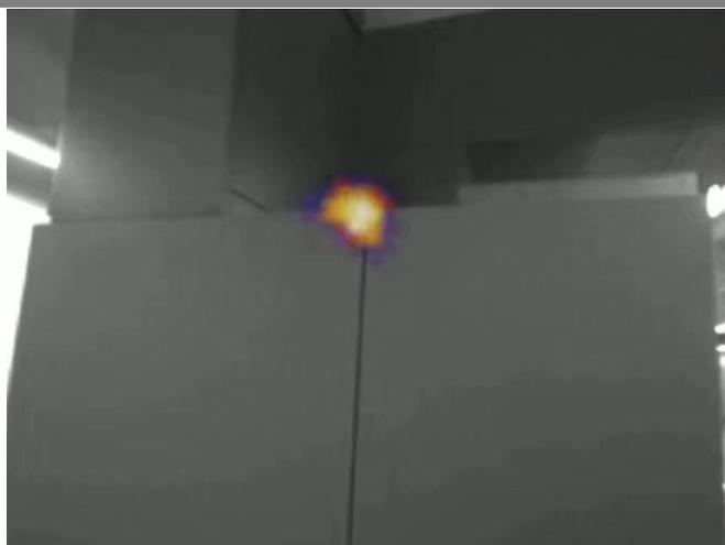
使用声学成像仪对电气柜内部设备设备进行局部放电排查
