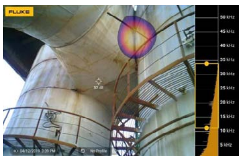
位置：PH 顶部 7 层 设备名称：双旋风筒 双旋风筒连接处漏气
