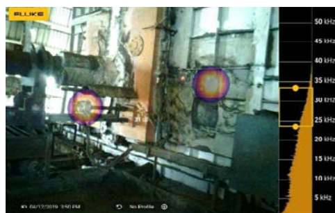
位置：烧成带 设备名称：窑罩 回转窑窑头漏气
