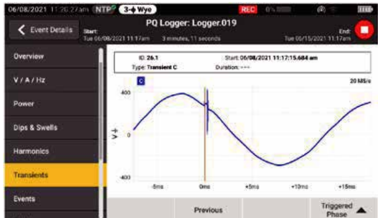
查看即時電壓瞬變事件，同時進行記錄以加快故障排除
